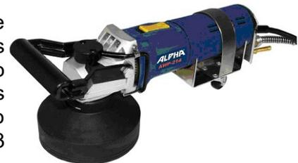
La maquina se utiliza también , para el lijado y pulido de pequeñas áreas, y eliminar los arañazos en los límites del suelo con las paredes, trabaja sin polvo al ir alimentada por agua.
