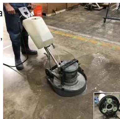
Las lijas Kirara también se pueden utilizar en máquinas de pulir manuales estándar, a un máximo 4000 rpm. Aunque están diseñadas para el pulido en húmedo, y se requiere poca agua en la superficie, una pulidora estándar junto con una botella rociadora puede servir para este propósito. También pueden usarse en una lijadora de doble acción u orbital, para mantener la superficie plana, pero también debe usar con una pistola rociadora de agua para humedecer la superficie.
