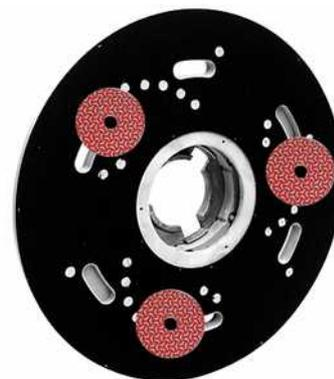
Las lijas Kirara se pueden usar en un plato de pulidora de suelos típica, a 175 rpm o 300 rpm. Las lijas Kirara vienen fijación por VELCRO, para que puedan instalarse en las almohadillas de pulidoras o abrillantadoras más populares. La cantidad mínima para aplicaciones en el piso es de 3 piezas por plato de pulidora de pisos, pero se pueden instalar 4 o más, para platos de mayor tamaño o diámetro.
