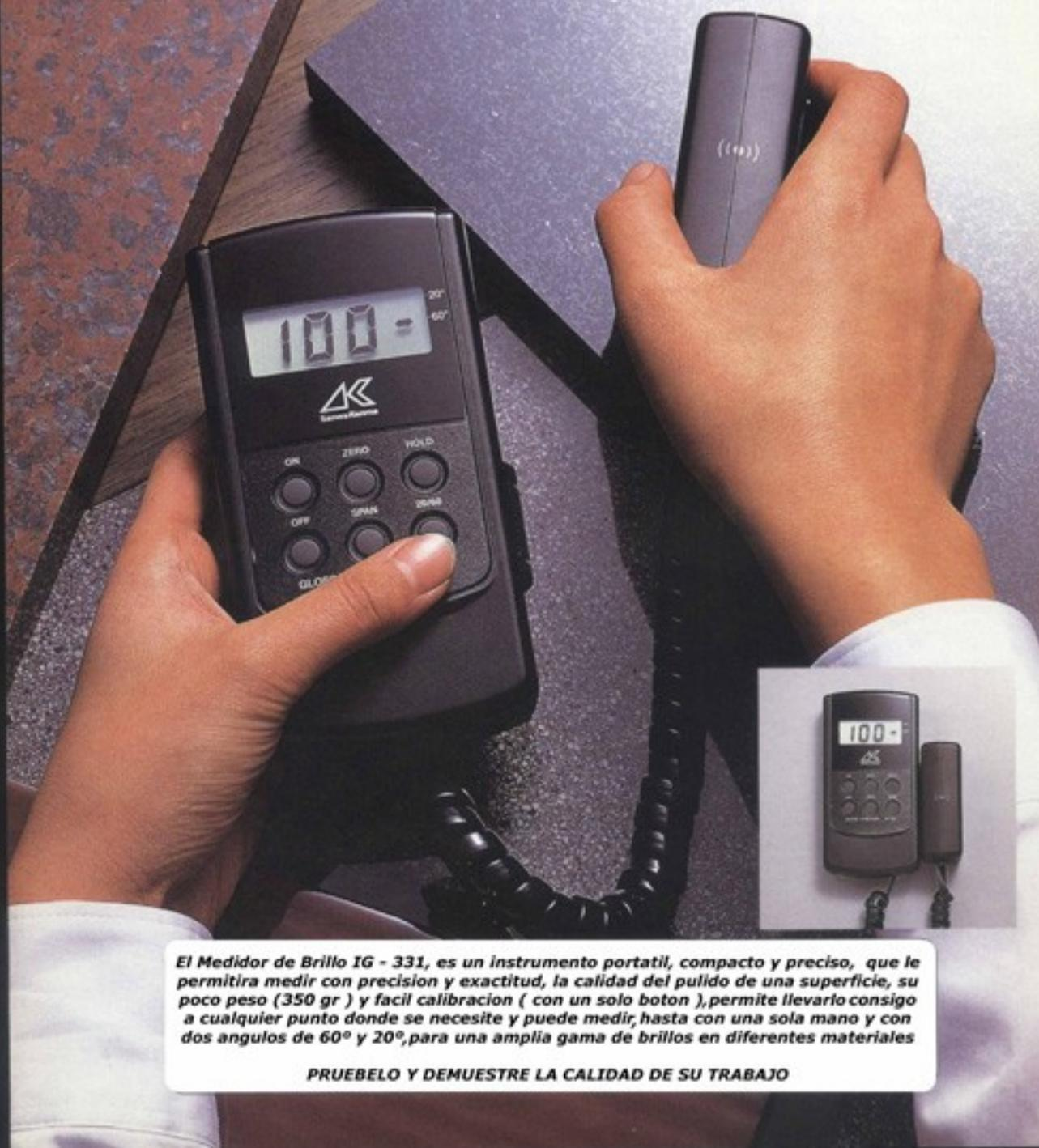
*El Medidor de Brillo IG - 331, es un instrumento portátil, compacto y preciso, que le permitira medir con precision y exactitud, la calidad del pulido de una superficie, su poco peso (350 gr ) y facil calibracion ( con un solo boton ),permite llevarlo consigo a cualquier punto donde se necesite y puede medir, hasta con una sola mano y con dos angulos de 60° y 20°,para una amplia gama de brillos en diferentes materiales*
