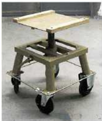
Mesa de altura regulable con capacidad de carga de 1000 kg.
