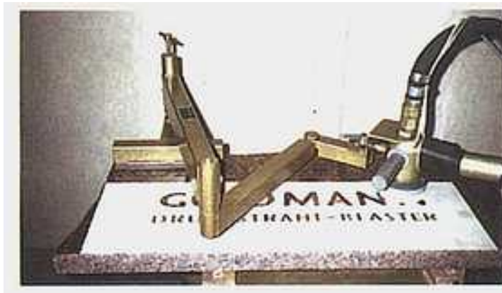
Brazo de guiado de cabeza articulado en tres puntos para un guiado sin esfuerzo sobre superficies planas
