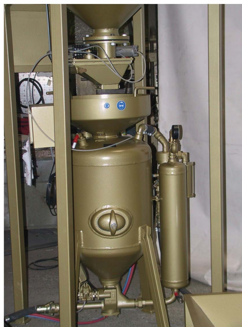
Valvula de guillotina neumática de recarga automática de abrasivo
