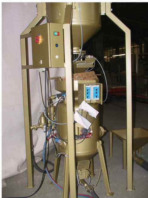
Sistema de sondas detectoras del nivel de abrasivo
